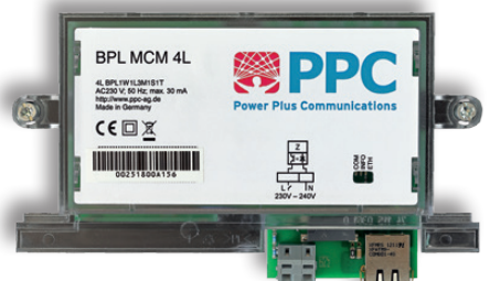
Dieses Gateway-Modul verfügt zusätzlich über eine Ethernet- und eine Wireless-M-Bus-Schnittstelle
