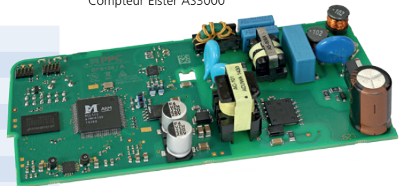
La nouvelle platine du module passerelle BPL de PPC s'intègre exactement dans le boîtier de la série de AM 100 à AM 500.
